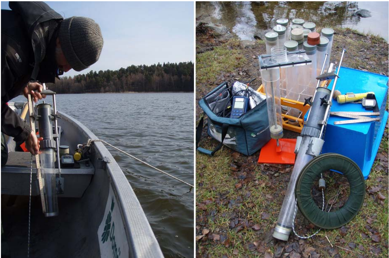
Figur 2. Provtagning och utrustning för sedimentprovtagning. Foto T. Jansson.
