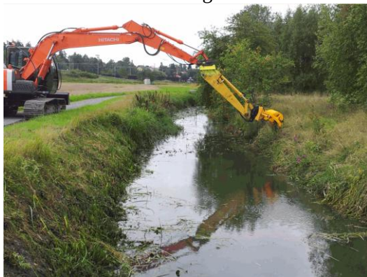
Klippskopa, fabrikat Herder, 2,5 m bred. Monterad på bandgrävare med förlängd arm, 11 m räckvidd. Foto Mats Eriksson, Sättra Gård
